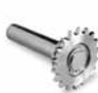
CRA1 Welle mit Ritzel mit 18 Zähnen, Ø der Welle 25,4 mm, Innen-Ø des Kranzes 25,4 mm. St./Pckg. 1
